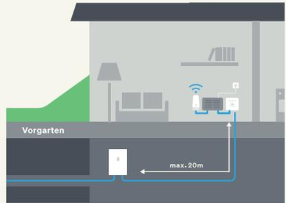
**12** Die Anbringung von GF-TA und NT (Glasfaser-Modem) erfolgen gemäß dem Begehungsprotokoll. Hierbei muss sich im Umkreis von 1,2 m zum NT eine 230-V-Stromanbindung befinden.
