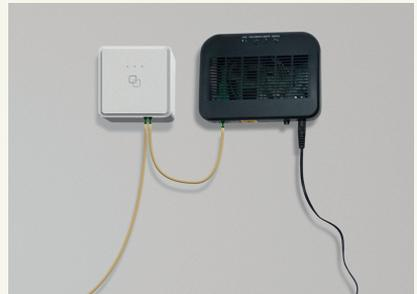
**14** Der NT wird mit einer eigenen ID gekennzeichnet. Diese identifiziert den Standort des NT eindeutig und kann somit automatisch dem Kunden zugeordnet werden.
